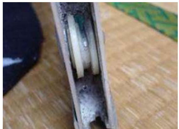
掃き出しアルミサッシの片方が減った戸車
