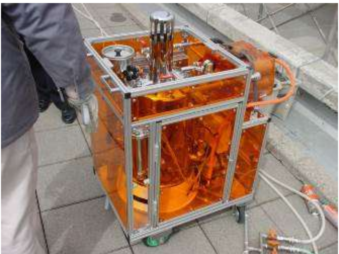
スチーム洗浄機:バルコニーなどサッシの近くに洗浄機を移動し、サッシ枠・框などを蒸気洗浄する。
