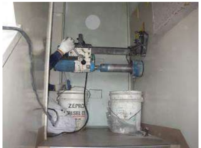
現地調査の様子（コンクリートコア採取）
