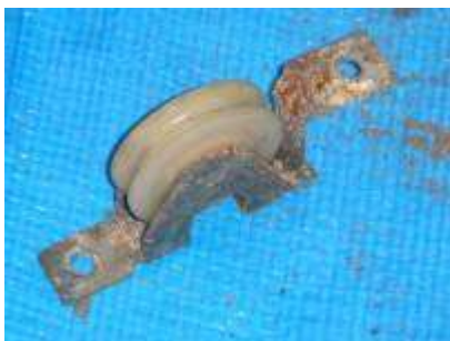
既存サッシの戸車 摩耗・錆発生
