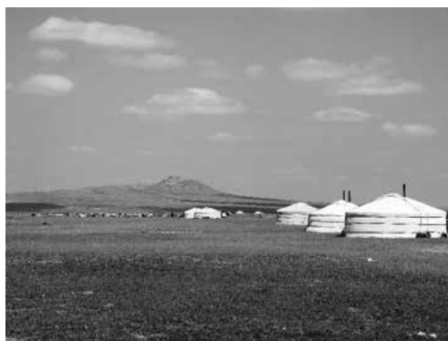
遊牧民は牧草を求めて移動し生活する。短時間に組み立てる50㎡程の移動式住居は強い地震を受けても、しなやかに建っている。
