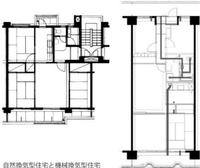
自然換気型住宅と機械換気型住宅
