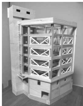
角地に建つ建物。解放された東南側構面を鉄骨ブレースで補強し、カーテンウォールで仕上げる。
